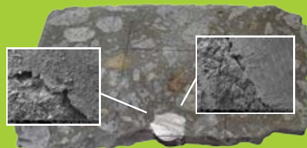
Obrázky z riadkovej elektrónovej mikroskopie medzi výstužou a betónom Zosnímané pri 80 násobnom zväčšení
