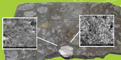
Obrázky z riadkovej elektrónovej mikroskopie medzi výstužou a betónom Zosnímané pri 4000 násobnom zväčšení
